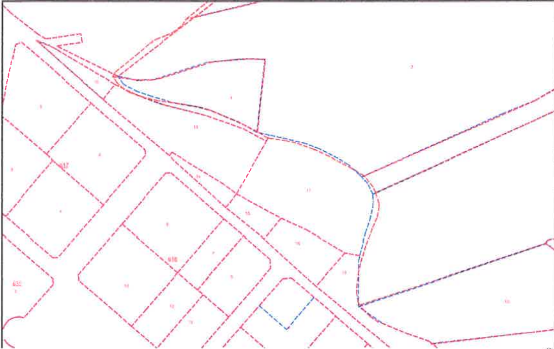
Şekil 9: Onaylı 1/1000 Ölçekli Uygulama İmar Planındaki Kadastral Sınırlar ile Çataltepe Mahallesi Kadastro Güncellemesi Sonrasında Kadastral Sınırlar
